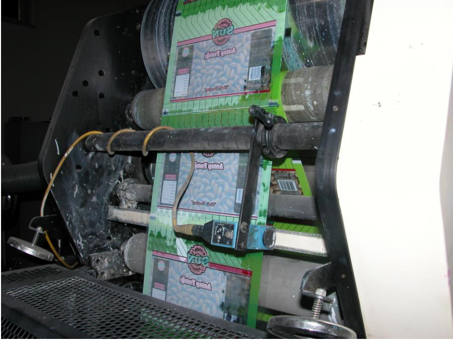
Resim4.12: Baskı ünitesi fotosel kontrolü
