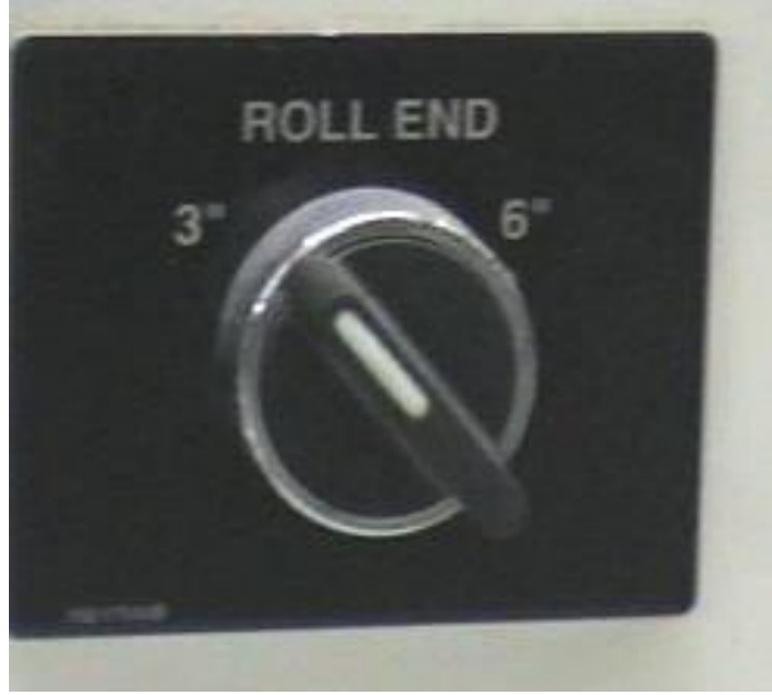
Resim4.3:Bobin azalmasını kontrol eden ayar butonu
